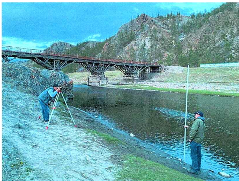
Зураг 1. Усны түвшний шонгийн нивелирдлэг хийж буй байдал
