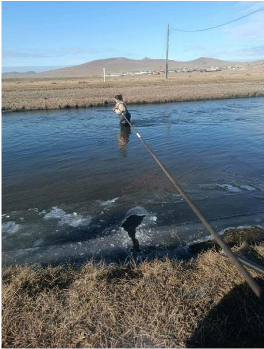
Зургийн тайлбар: Өвлийн улиралд усны өнгөрөлт хэмжиж буй байдал (нэг удаагийн өнгөрөлт хэмжилтэд 3-5 цагийг зарцуулдаг, ажиллах орчинд усны температур 0-1 градус, агаарын температур -15°C градусаас доош байдаг)
