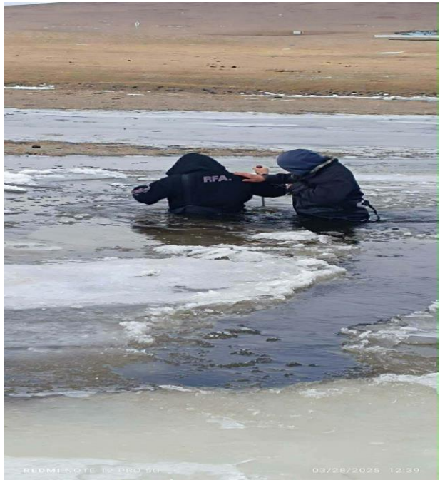
Зургийн тайлбар: Өвлийн улиралд усны өнгөрөлт хэмжиж буй байдал (нэг удаагийн өнгөрөлт хэмжилтэд 3-5 цагийг зарцуулдаг, ажиллах орчинд усны температур 0-1 градус, агаарын температур -15°C градусаас доош байдаг)
