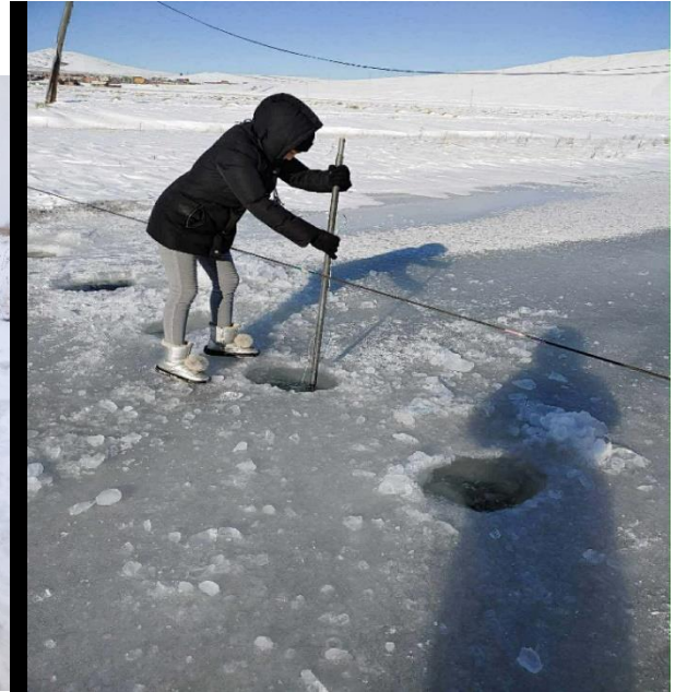
Зургийн тайлбар: Өвлийн улиралд усны өнгөрөлт хэмжиж буй байдал (нэг удаагийн өнгөрөлт хэмжилтэд 3-5 цагийг зарцуулдаг, агаарын температур -15^{\circ}\text{C} -30^{\circ}\text{C} градусуас доош байдаг)
